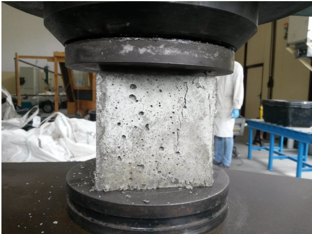
Fot. 4. Badanie wytrzymałości na ściskanie
