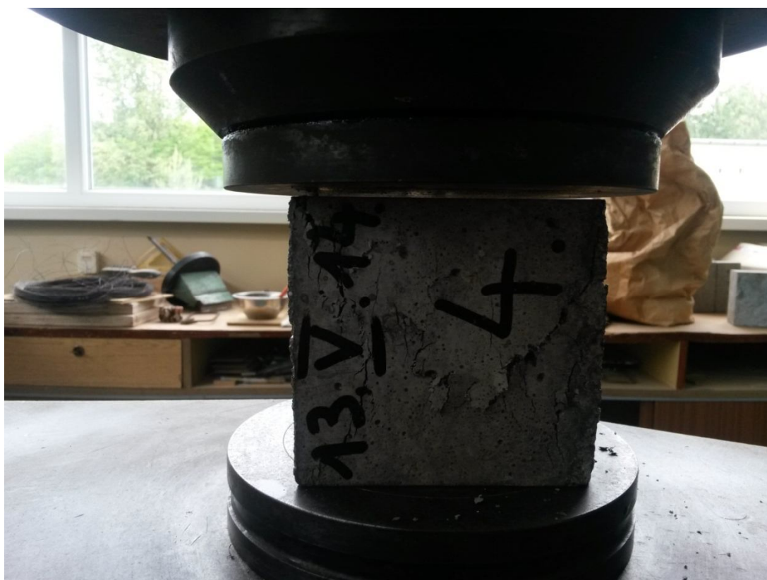
Fot.3. Badanie wytrzymałości na ściskanie
