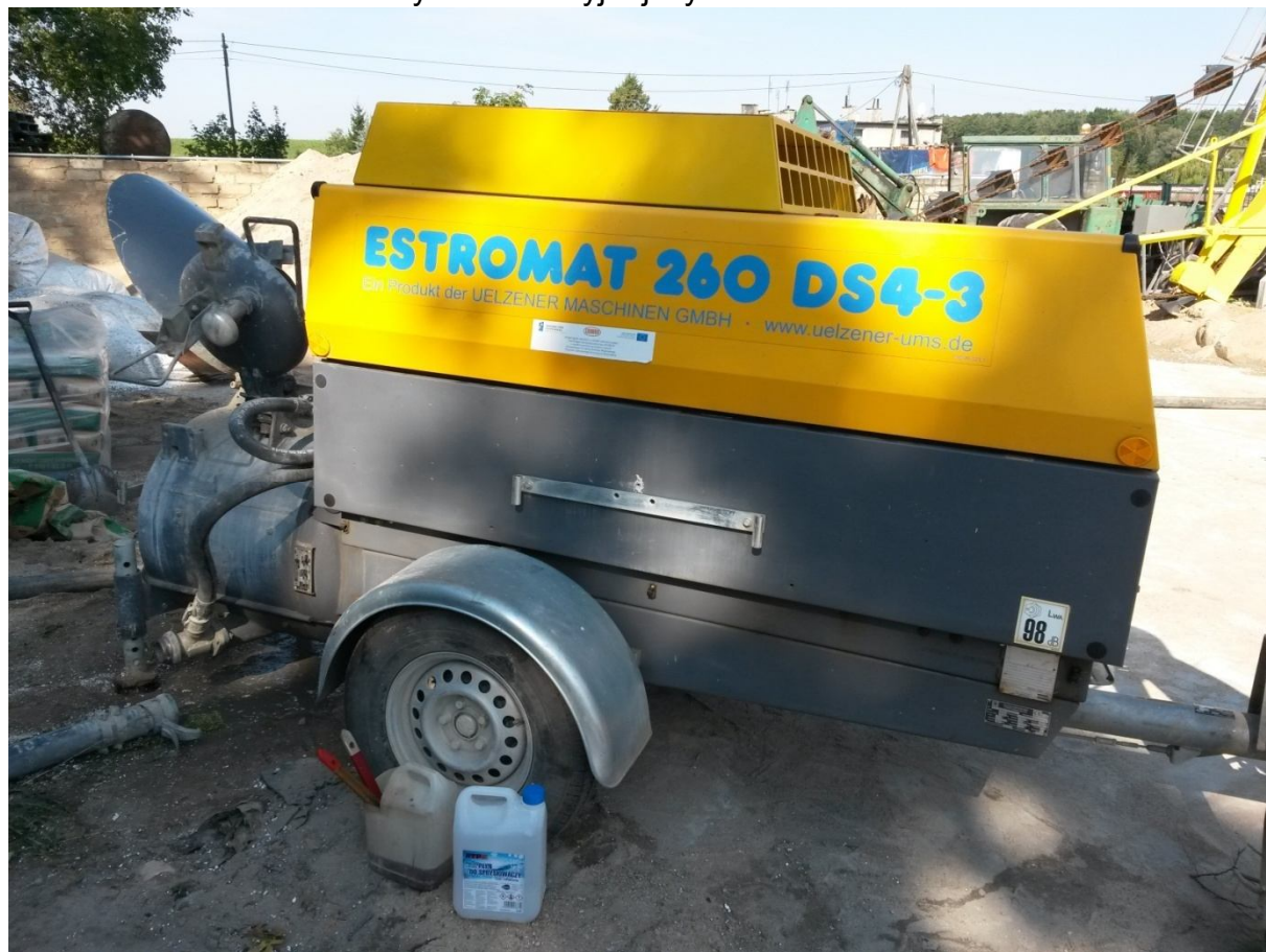
Fot. 6. Urządzenie mieszające i podające mieszankę Estromat 260 DS4-3
