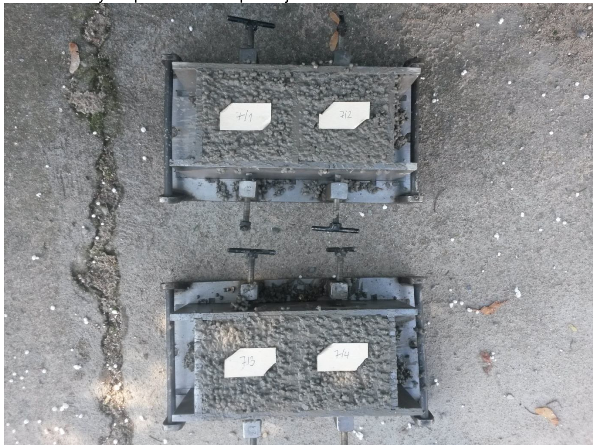
Fot. 11. Część próbek pobranych do badań wytrzymałościowych
