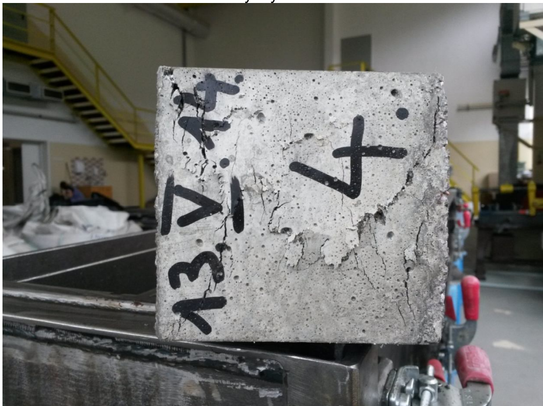
Fot. 5. Próbką po badaniach wytrzymałościowych
