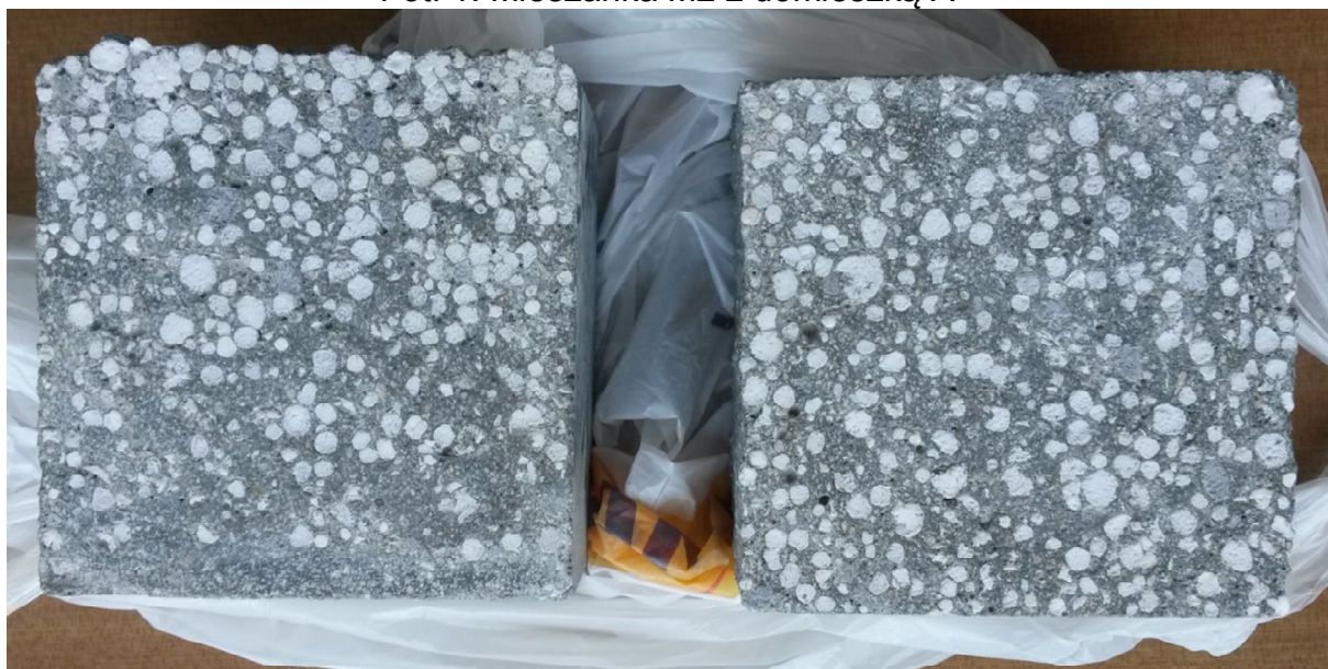
Fot. 2. Przekrój wybranych próbek wykonanych podczas prób pilotażowych – z domieszką B (lewa strona, widoczna segregacja składników) oraz z domieszką A (prawa strona)
